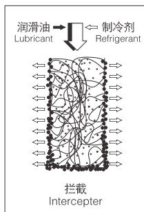
从压缩机输出的带有悬浮油颗粒的气态制冷剂进入到油分离器中，气态制冷剂携带的油经过进口金属丝网和带有隔板的出口金属丝网的拦截，油颗粒之间相互撞击并形成较重的油颗粒，这些较重的油颗粒最终撞击在油分离器的内壁上，此处具有最终分离作用。被分离出来的油滴落到油分离器的底部，并通过此处安装的浮球式针阀将油返回到曲轴箱或储油器中。
